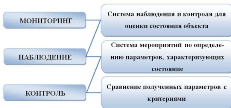
Рисунок 1 – Система технического мониторинга строительных объектов
