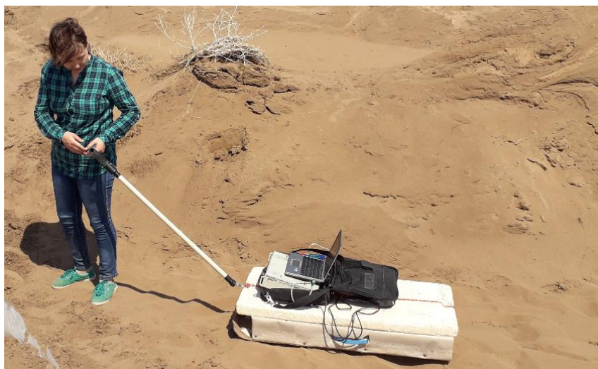
Сурет 1 - Георадар "Зонд-12e"
